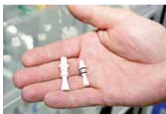
Eine Herausforderung sind Keramikdüsen. Sie schrumpfen bei der Herstellung um 20 Prozent.
