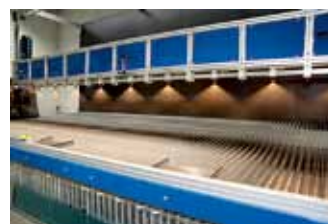
Bei der Kontrolle der Düsen werden strenge Maßstäbe an den Variationskoeffizienten gelegt.
